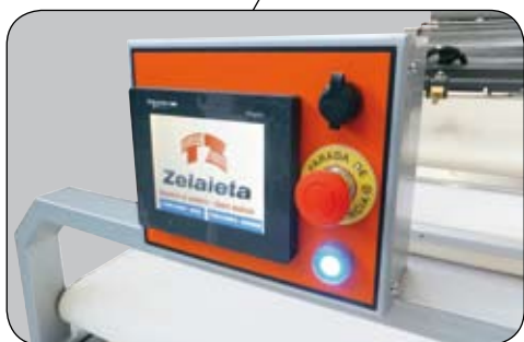
Панель управления через автомат
