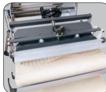
Формовщик FTZ-600S-DR DYNAMIC с режущей системой для мелкого хлеба.
